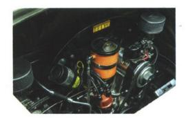
Stolze 55 PS leistet der 1.488 cm<sup>3</sup> große Vierzylinder, die er bei 4.400/min zur Verfügung stellt. Mit der Alu-Karosserie dürften 160 km/h erreichbar sein.
